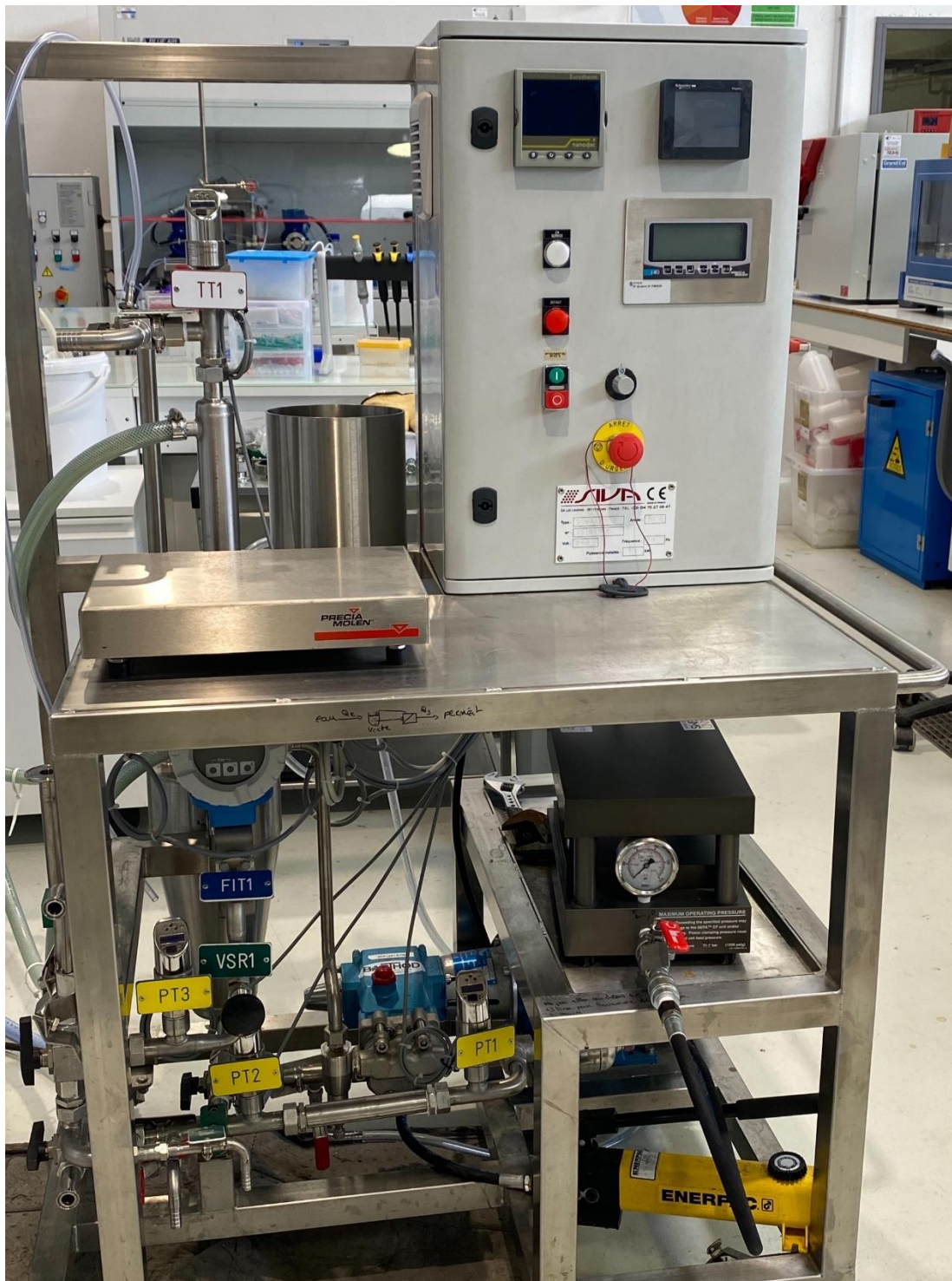
Pilote de filtration tangentielle : SIVA SivaLab
